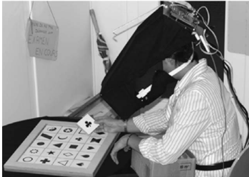
Figure 28 : Tâche visuo-motrice en vision prothétique. Les sujets doivent regarder la forme imprimée sur l'objet qu'ils ont en main puis déposer l'objet sur la forme en question présente sur le tableau devant eux. Source : [Pérez Fornos et al. 2008]
