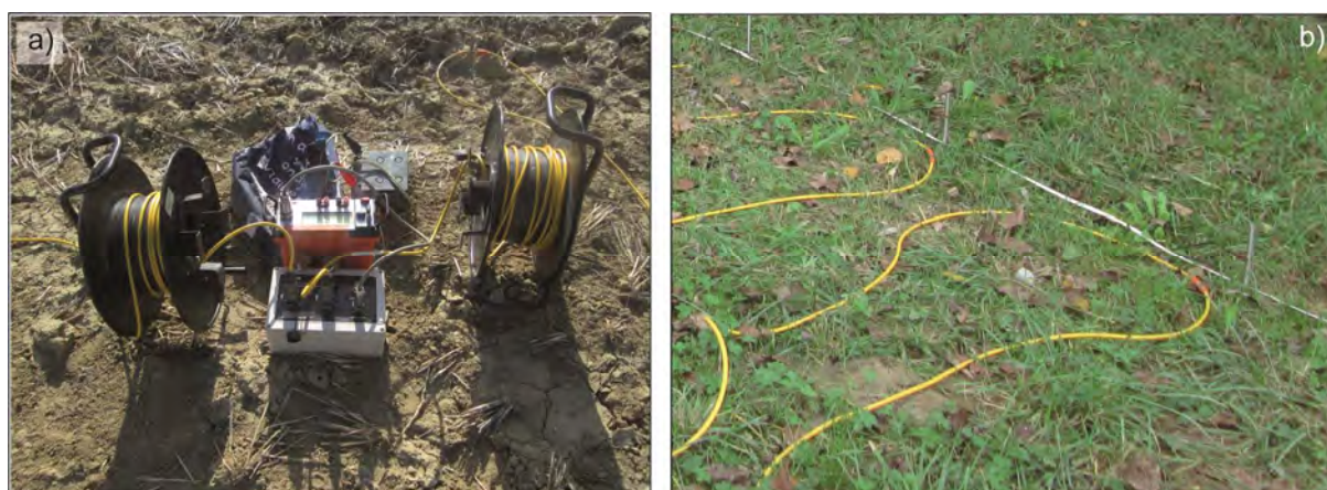
Figure 7.27 : Photographies du matériel utilisé pour les mesures de résistivité électrique. a) Dispositif TerraMeter ABEM SAS 1000 ; b) Electrodes positionnées à la surface du sol et reliées entre elles par un câble électrique.
