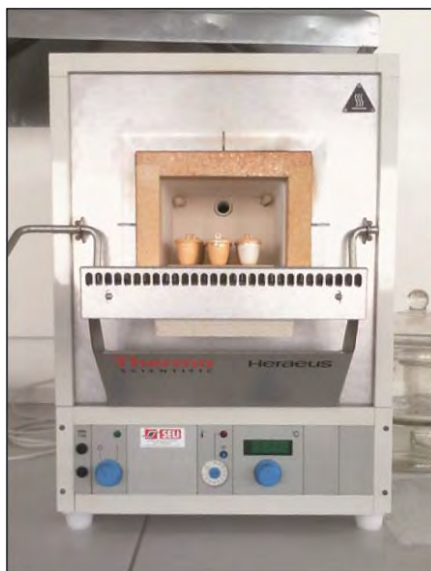
Figure 7.21 : Refroidissement des creusets contenant les échantillons de sédiments après 4 h de cuisson à 550° dans le four à moufle.
