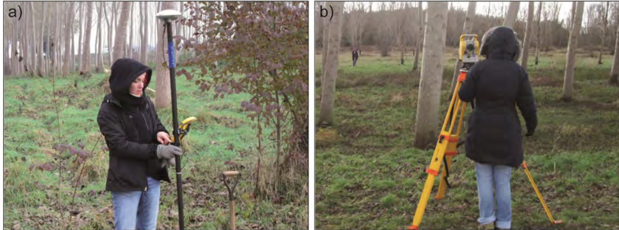
Figure 7.28 : Photographies des sessions de mesures topographiques. a) Mesures au DGPS ; b) Mesures au théodolite.
