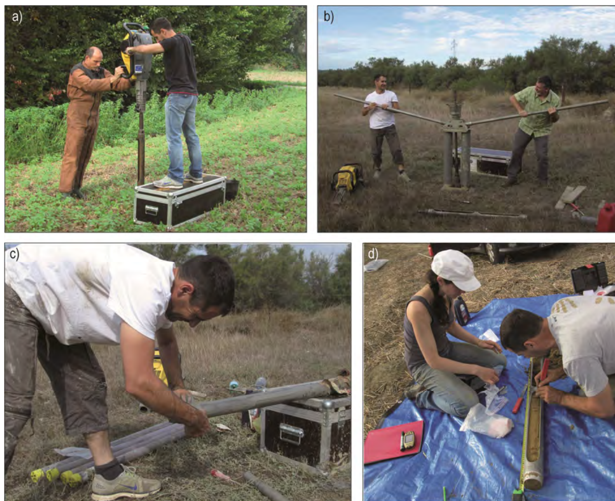
Figure 7.18 : Photographies montrant les techniques et outils utilisés pour le prélèvement des carottes et échantillons sédimentaires. a) Enfoncement de la gouge au vibro-percuteur ; b) Extraction de la gouge à l'extracteur à bras de levier ; c) Evacuation et référencement d'une carotte tubée (prélèvement à la gouge fermée) ; d) Sous-échantillonnage sur site d'une carotte non tubée (prélèvement à la gouge ouverte)
