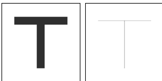
Figura 2.17: Patró en forma de T i el seu respectiu esquelet
