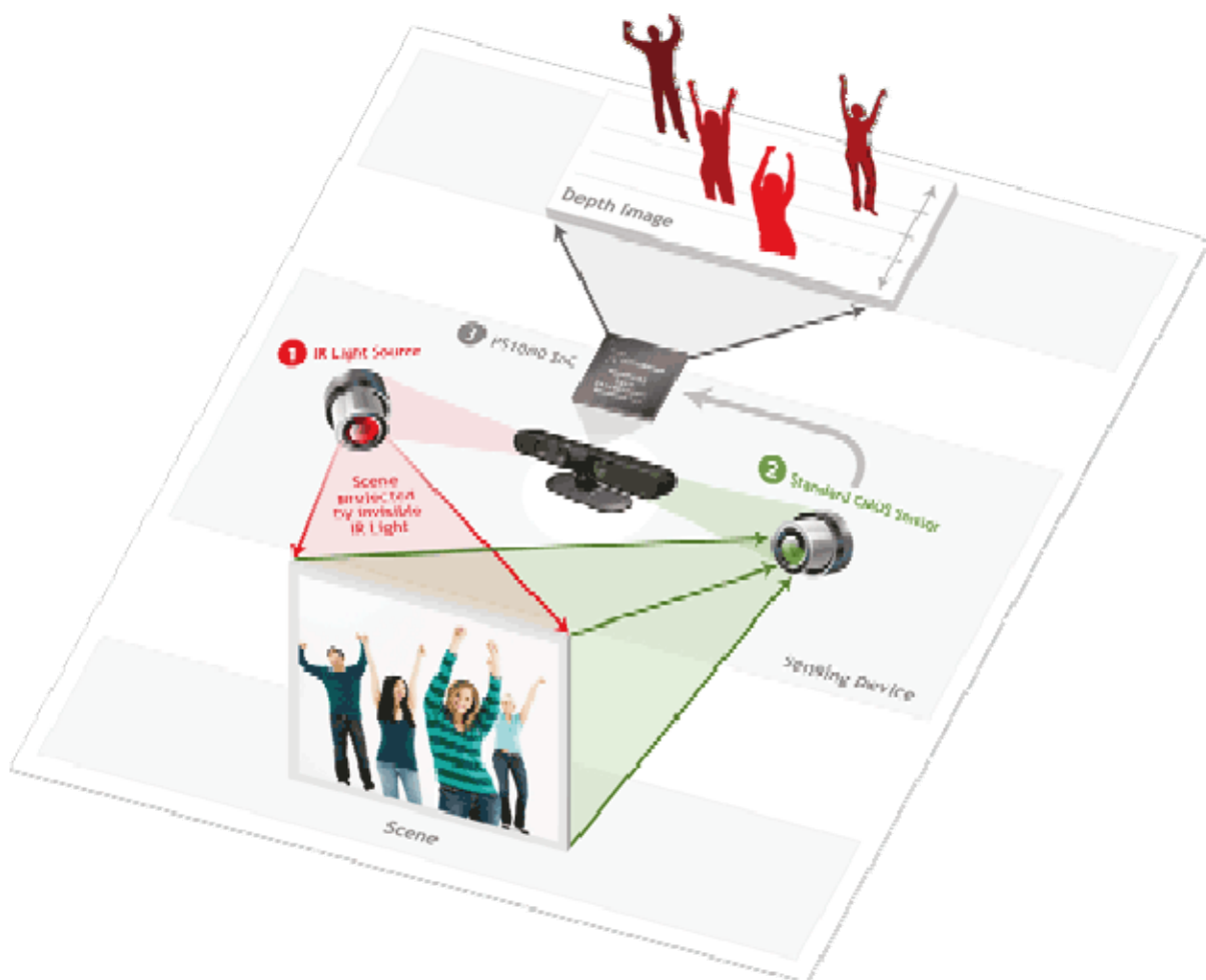
Figura 2.12: Captura de profunditat del sensor PS1080 de PrimeSense [11]
