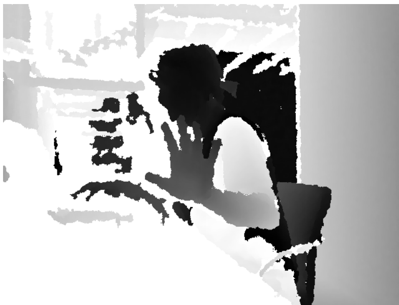
Figura 3.6: Imatge de la profunditat convertida a format 8 bits escala de grisos
