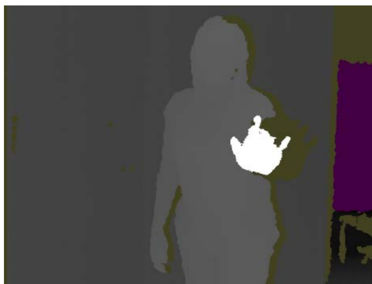
Figura 2.15: Representació de profunditat mitjançant Microsoft Kinect SDK
