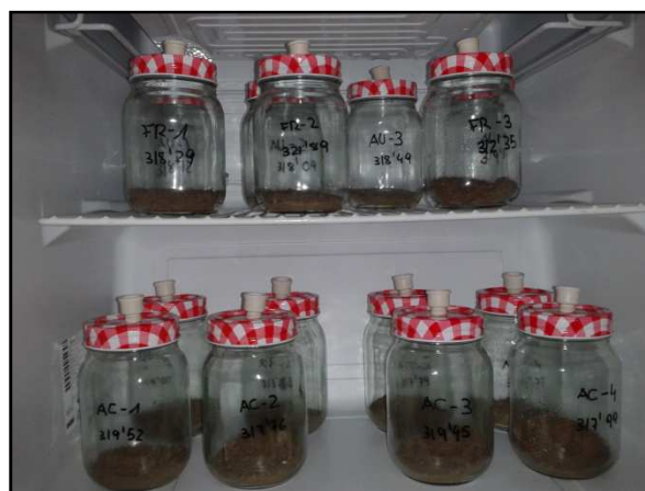
Figura 7. Muestras de suelo en incubación y tapadas herméticamente.
