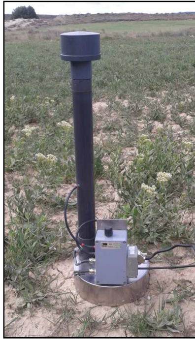
Figura 6. Cámara abierta modelo CFX-1
