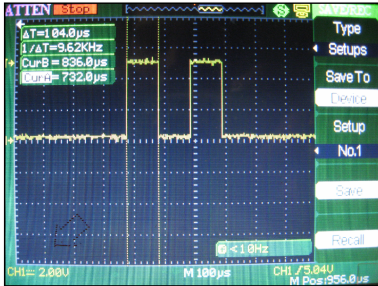
Fig. 3.5.12 Temps de bit i baud rate obtinguts.
