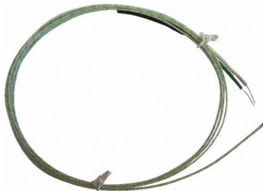
Fig. 2.5.4 Termoparell tipus J amb junta d'unió lliure
