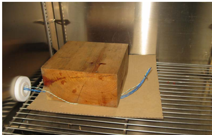
Fig. 5.2.2 Col·locació dels 3 termoparells pel calibratge del sistema.
