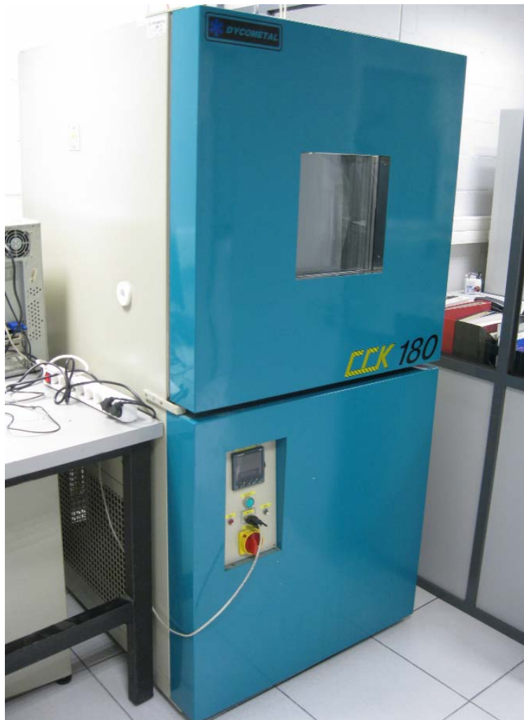
Fig. 5.1.1 Càmera climàtica utilitzada per les proves a Elausa
