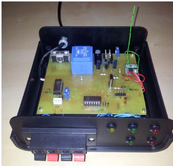
Fig. 4.5.2 Detall de l'interior de la caixa del PCB
