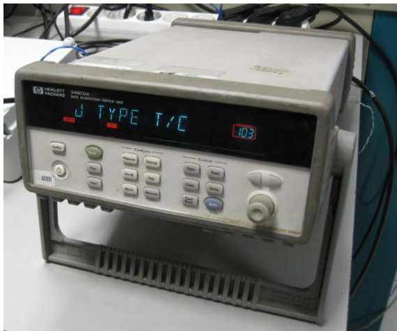
Fig. 5.2.1 Mòdul Hewlett Packard utilitzat pel calibratge del sistema.
