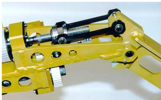
FIG. 1.8: Système de transmission au niveau du genou
