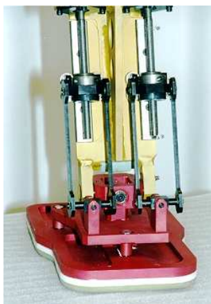
FIG. 1.9: Robots parallèles de la cheville
