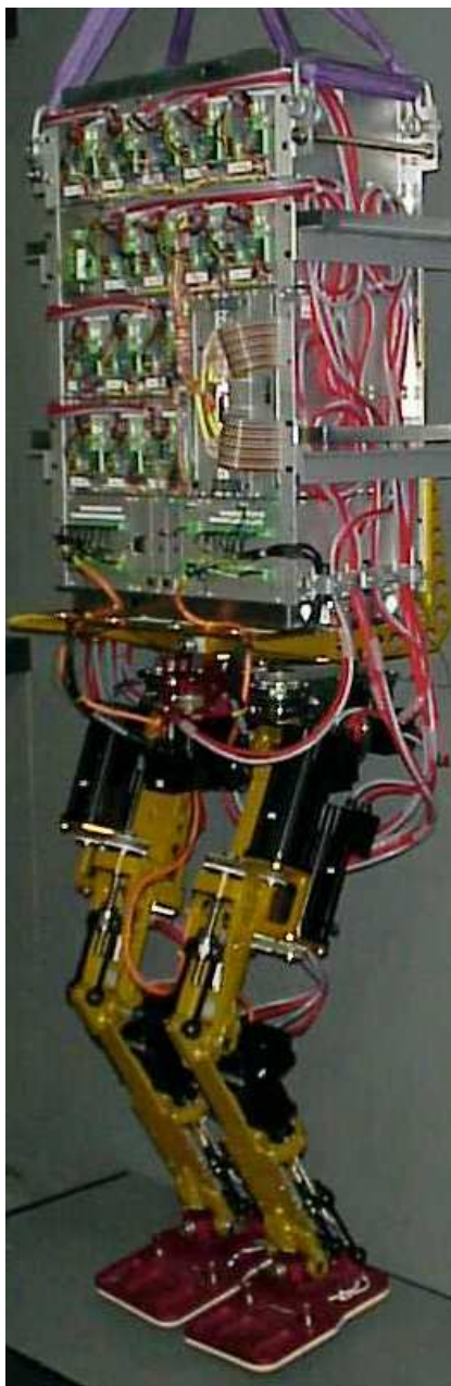
FIG. 1 – Le robot bipède bip2000
