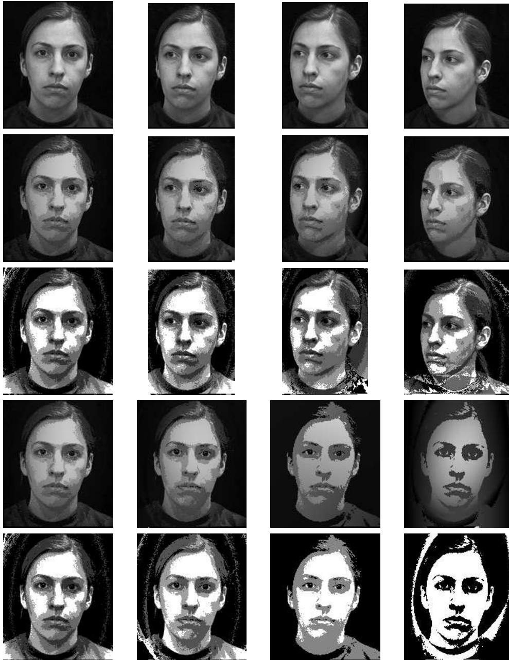
FIG. 17 – Les images originales d'un visage avec différentes orientations sont sur la première ligne. Sur la deuxième ligne, ces images sont segmentées en 5 classes qui ont une variation quadratique de l'intensité. La troisième ligne présente les images de labels associées. Sur la quatrième ligne, la segmentation du visage vu de face, avec 5, 4, 3 et 2 classes est visible. Les images de label associés sont sur la cinquième ligne.
