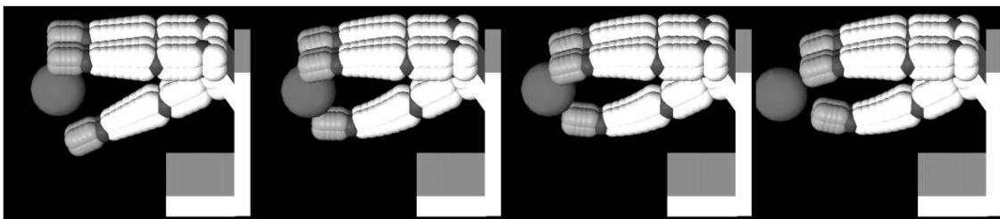
FIG. 3.23 - : Glissement d'une balle au moment de la saisie avec une main articulée. Glissement causé, soit par de mauvais paramètres de contrôle (ici, les paramètres liés à la friction), soit par une mauvaise configuration initiale avant la saisie.
