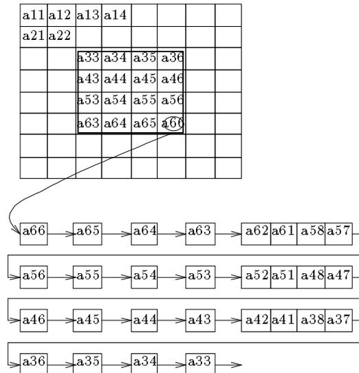
Figure 15 : Décalage des données dans la machine Cytocomputer.
