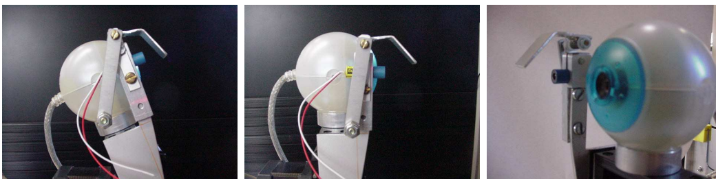
Fig. 2.4 : Robot : Le pointeur laser et sa protection anti-éblouissement
