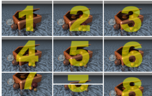
FIG. 33 – Représentation de l'image mosaïque constituée de 8 vues non entrelacées : une compression par bloc (type jpeg) peut donc être appliquée sur ce type d'image : les numéros indiquent la position relative de chaque vue dans l'image complète.
