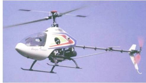
FIG. 2 – Drone hélicoptère (PY Automation).
