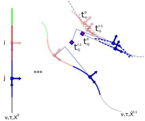
FIG. 4 – L'isométrie de la région  $j$  fournit une prédiction du mouvement du centre de la région voisine  $i$ . La pose de référence à  $t = 0$  et la pose précédente à  $t - 1$  sont utilisées pour cette prédiction.
