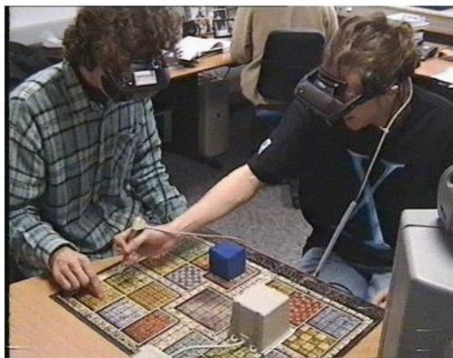
FIG. 6 – Deux utilisateurs manipulant des objets virtuels intégrés dans l’environnement réel. Ils peuvent librement interagir avec les objets tout en gardant la possibilité de communiquer par voie orale, et gestuelle.
