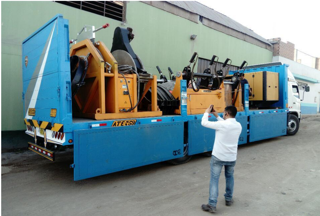
Figura 10. Máquina de termofusión para trabajos con Sedapal en Planta Lurín
