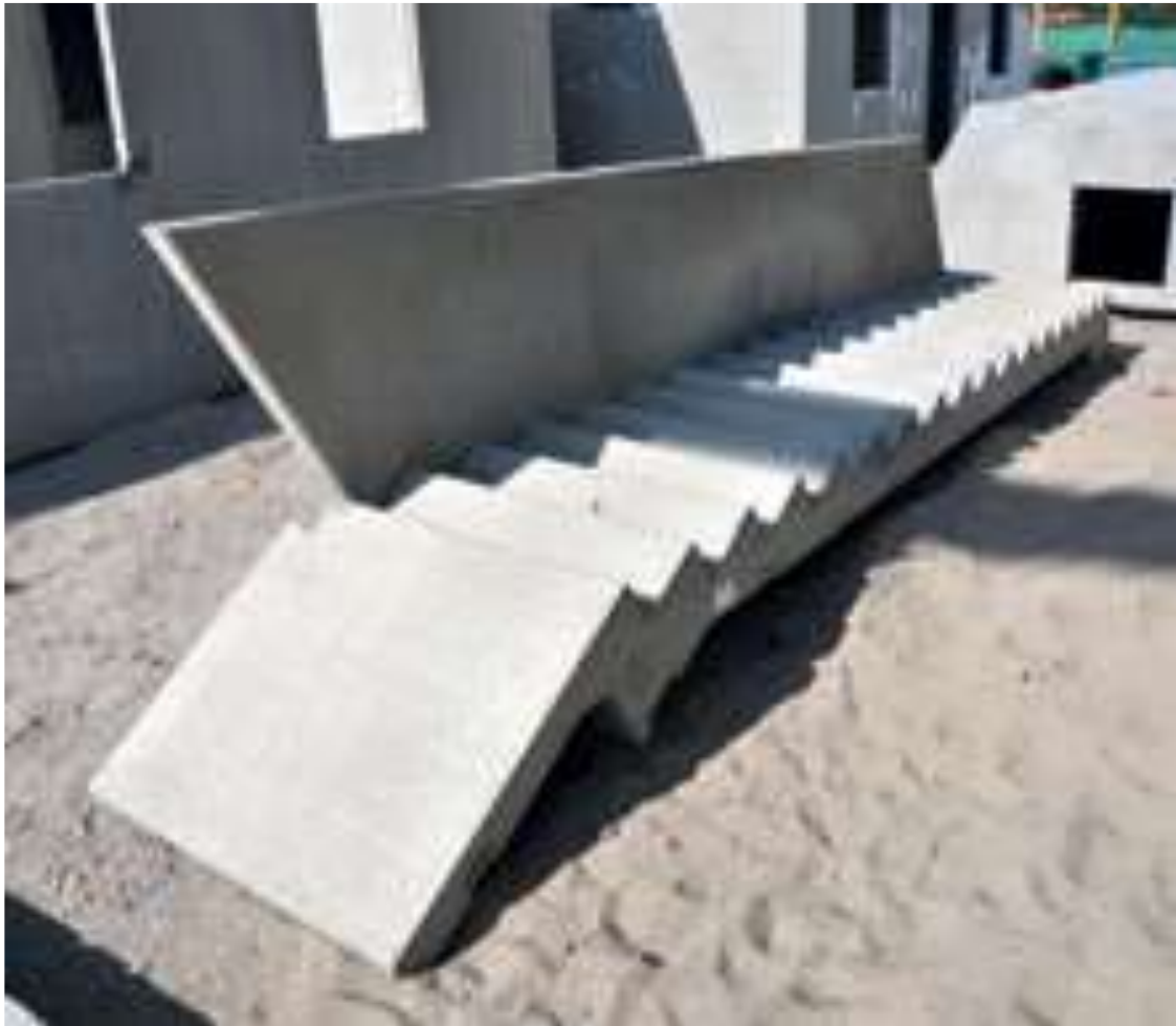
Figura 49. Paralelamente se producen escaleras por separado. Fuente: http://revistapyc.com .
