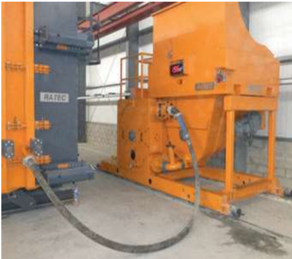
Figura 43. Conexión de la bomba al encofrado. Fuente: http://revistapyc.com .
