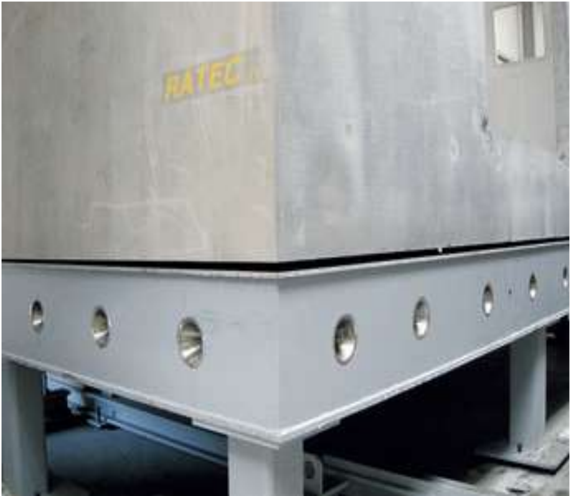
Figura 45. Cantos afilados y superficies lisas de encofrado en todos los lados. Fuente: http://revistapyc.com
