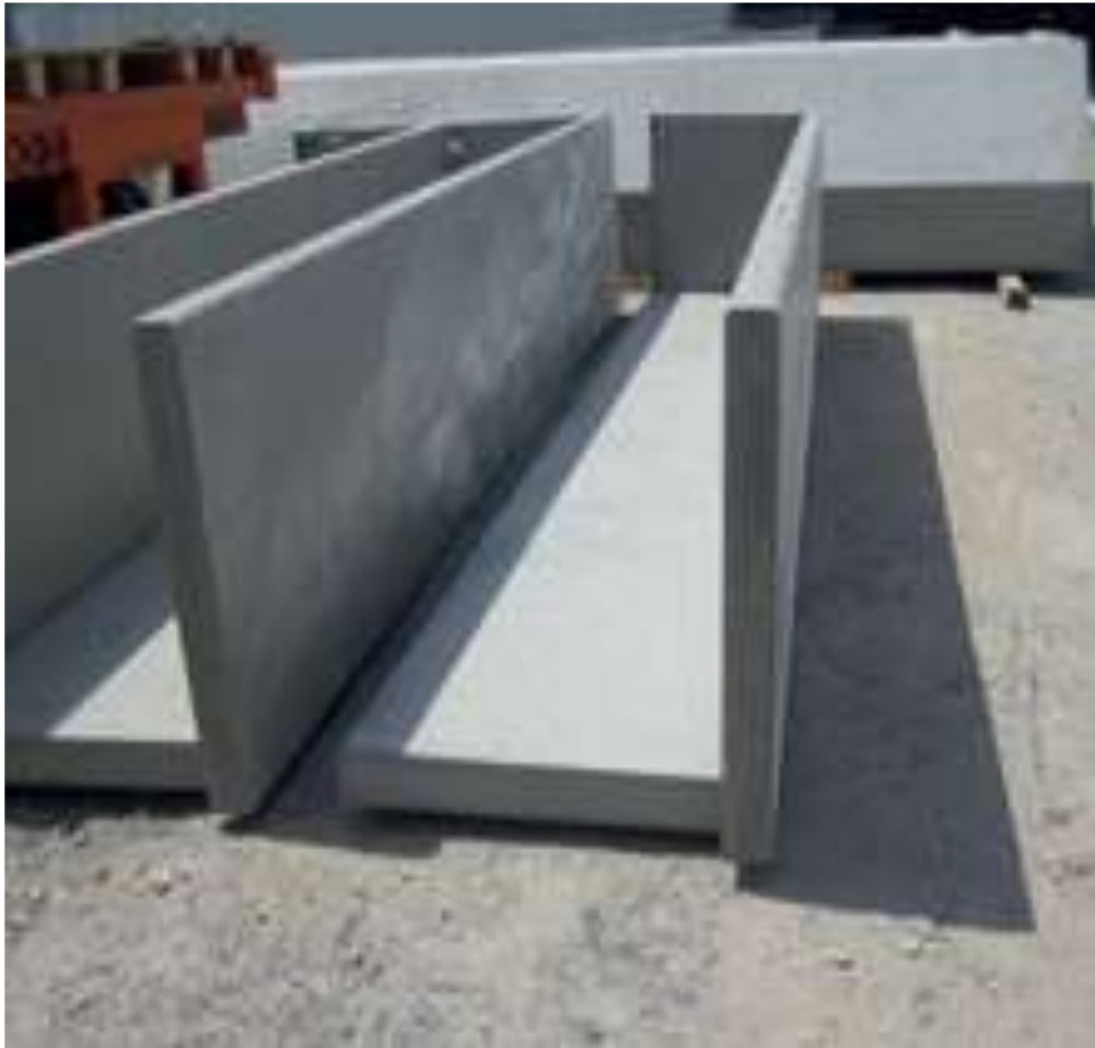
Figura 50. Paralelamente se producen balcones por separado. Fuente: http://revistapyc.com .
