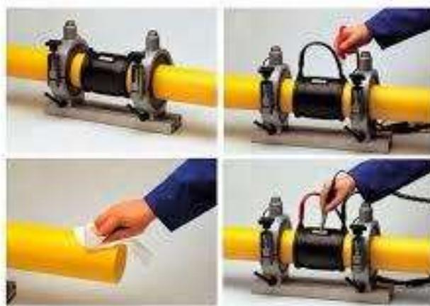
*Figura 22: Termofusión a Silleta.*
