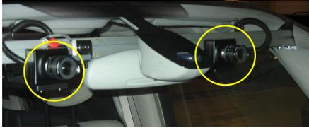
FIG. 10 – Paire de caméras montées derrière le pare-brise du véhicule d’essai.
