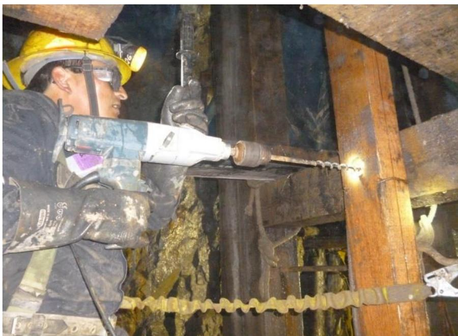
*Figura N20: Perforación de taladros en guías con equipos de poder \_ Unidad Austria Duvaz*
