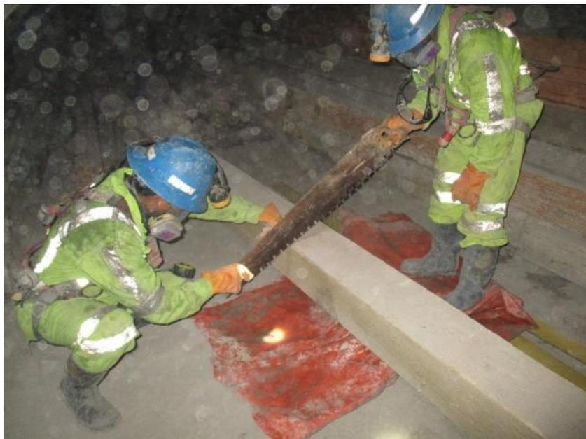
Figura N22: Cortes de madera con uso de corvinas.
