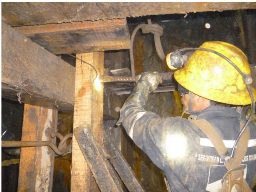
*Figura N19: Perforación de taladros en guías en forma manual \_ Unidad Austria Duvaz*
