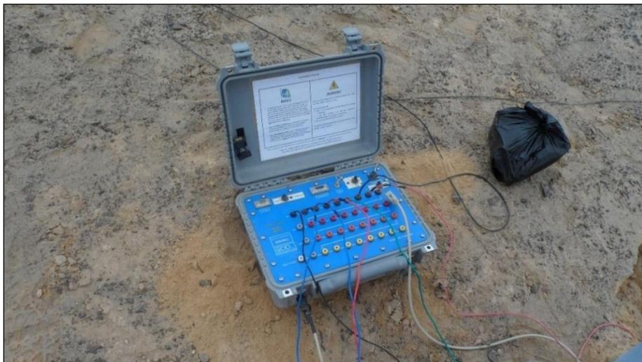
*Figura 22. Equipo receptor GEODE de 32 canales. (Pelaez, 2021)*
