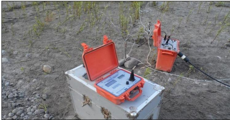
*Figura 23. Equipo transmisor TIP5KW. (Pelaez, 2021)*
