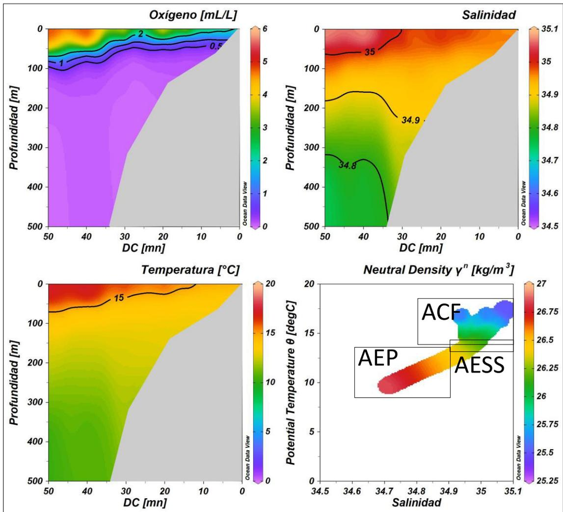
**Figura 13.** Distribución vertical de oxígeno disuelto, salinidad, temperatura; el eje X, indica la distancia a la costa (DC), el eje Y, la profundidad de la columna de agua y la plataforma continental es graficada de color gris y el diagrama Temperatura – Salinidad, donde se identifica las masas de agua frente a Callao (12° S).
