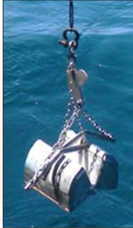
**Figura 11.** Draga van Veen de 0.05 m<sup>2</sup> de cobertura.
