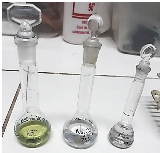
De izquierda a derecha se muestran las soluciones del RFC, Na 2 CO 3 y ácido gálico
