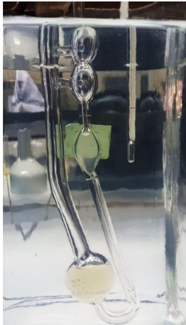
Determinación de la viscosidad a 30°C
