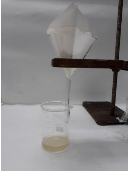
Filtración antes de la medición de pH
