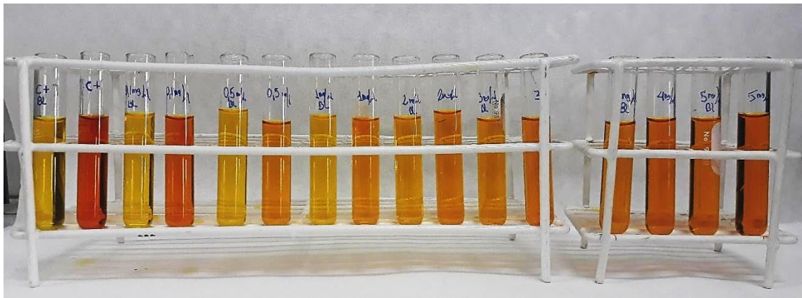
Tubos de reacción de controles, blancos y acarbosa con una concentración creciente de izquierda a derecha*
