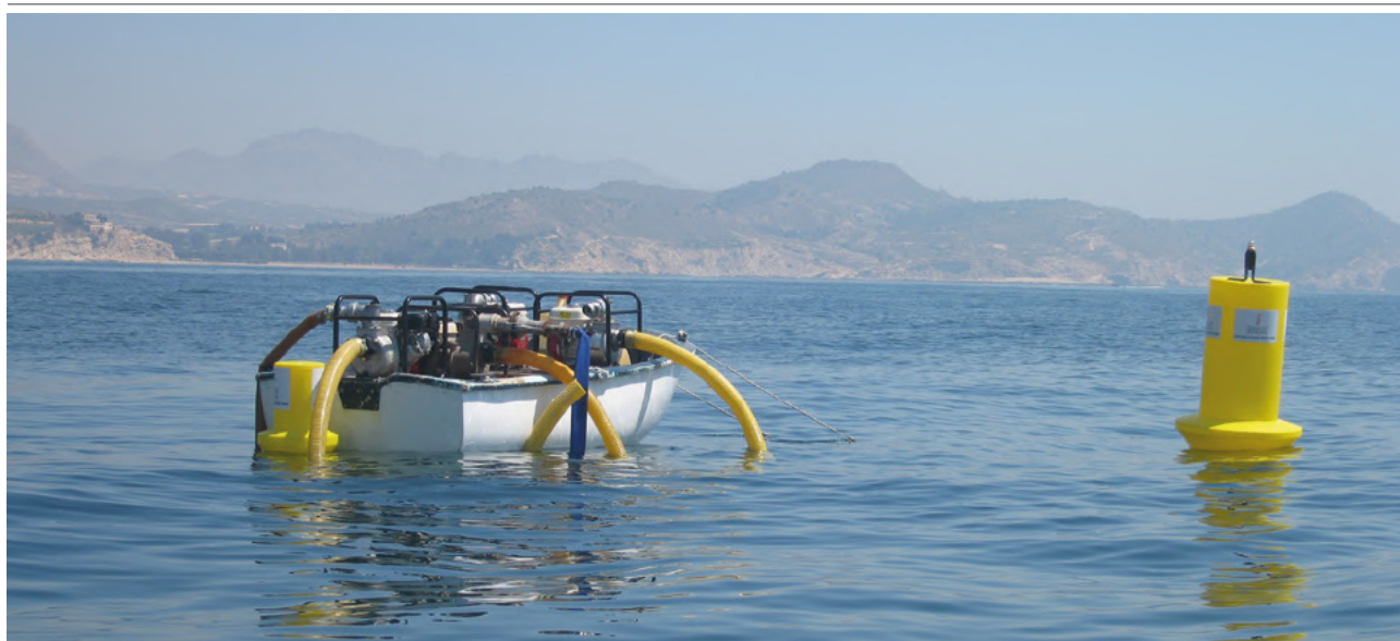
Figura 32. Bot amb motobombes per impulsar les mànegues de succió per aigua. Campaña 2007. / Bote con motobombas para impulsar las mangas de succión por agua. Campaña 2007. Autor: C. de Juan.
