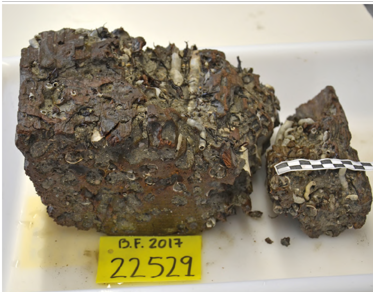
Figura 210. Atac generalitzat de Teredo navalis a la segona traca de paralla. / Ataque generalizado de Teredo navalis en la segunda traca de aparadura. Autor: CASC (Centre d'Arqueologia Subaquàtica de Catalunya - Museu d'Arqueologia de Catalunya).
