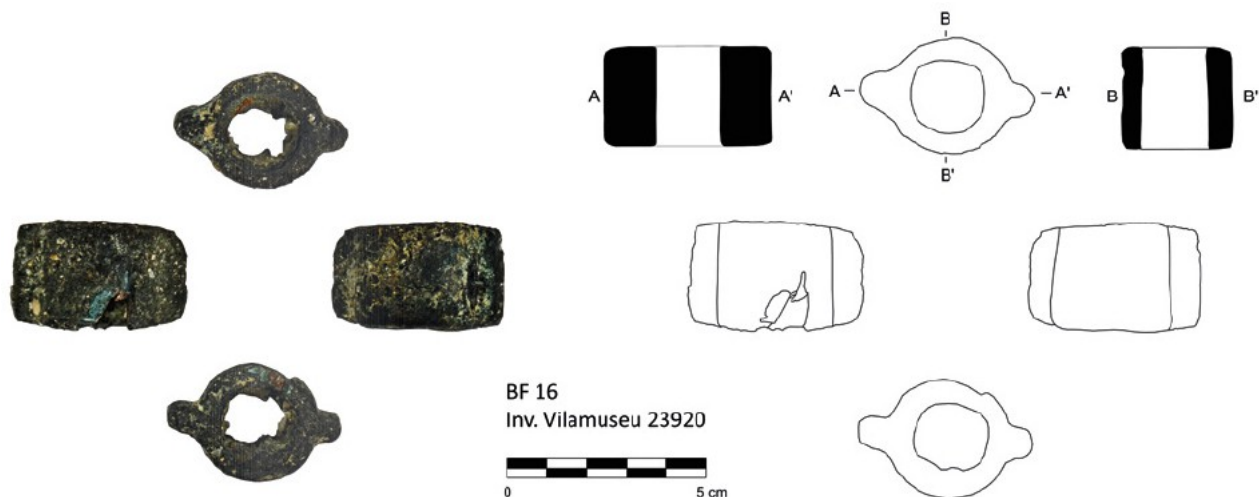
Figura 169. Rodament de bronze ternari del Bou Ferrer. Dibuix d'Israel Serna Martínez. / Rodamiento de bronce ternario del Bou Ferrer. Dibujo de Israel Serna Martínez.
