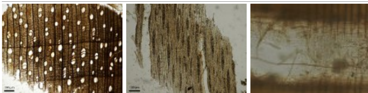
Figura 150. Carpí ( Carpinus betulus L.), tall transversal, tangencial i radial (mostra C124) / Carpe ( Carpinus betulus L.), cortes transversal, tangencial y radial (muestra C124). Autora: A. Ferreira Domínguez AMU/CCJ-EFR.
