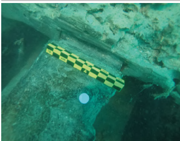
Figura 125. Vista de l'encaix de la sobrequilla sobre una varenga, a la qual al seu torn se li treballa el dors superior per a un acoblament perfecte. / Vista del encaje de la sobrequilla sobre una varenga, a la que a su vez se le trabaja su dorso superior para un acople perfecto. Autor: C. de Juan.
