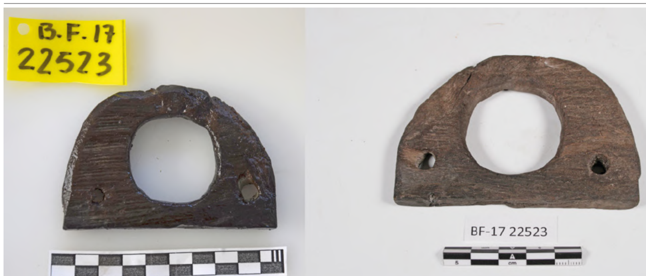
Figura 213. Guia de carregadora abans (esquerra) i després (dreta) de la liofilització. / Guía de cargadera antes (izquierda) y después (derecha) de la liofilización. Autor: CASC.
