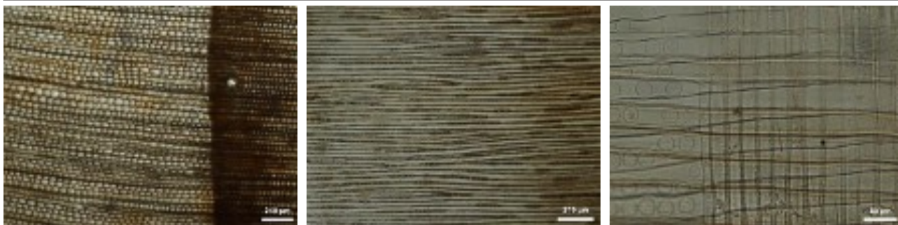
Figura 151. Pi d'Alep/pi pinyer ( Pinus halepensis Mill./ Pinus pinea L.), talls transversal, tangencial i radial (mostra V-2) / Pino de Alepo/pino piñonero ( Pinus halepensis Mill./ Pinus pinea L.), cortes transversal, tangencial y radial (muestra V-2). Autora: A. Ferreira Domínguez AMU/CCJ-EFR.
