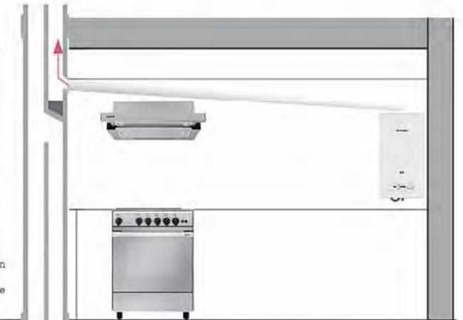
**DETALLE DEL EMBELECEDOR EN FACHADA PARA OCULTAR LOS TUBOS DE GAS Y LAS ABERTURAS DE VENTILACIÓN.**
