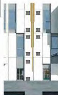
Se opta por cubrir con una chapa de acero perforada, que mantiene la estética moderna, plana, y permite perfectamente la ventilación en toda la parte de fachada donde es necesaria. Se ha puesto como ejemplo la chapa perforada de acero inoxidable de la casa Nomen.
