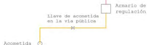
PLANTA BAJA: mostrando localización de acometida y armario de regulación, así como el recorrido horizontal de la montante.
