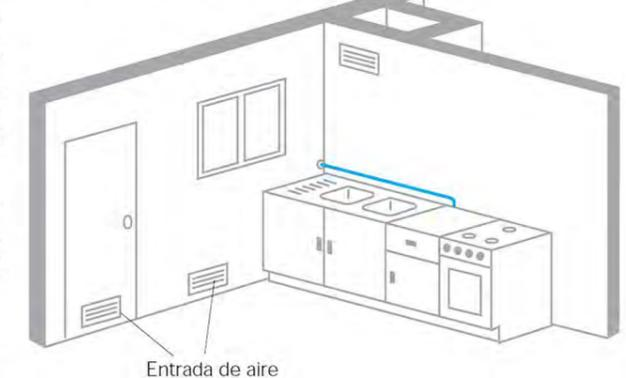
Nuestra potencia total instalada es de 53,4 Kw por tanto la superficie de la rejilla debera ser de 100cm<sup>2</sup> + 50 cm<sup>2</sup> ya que la entrada se efectúa por conducto.
