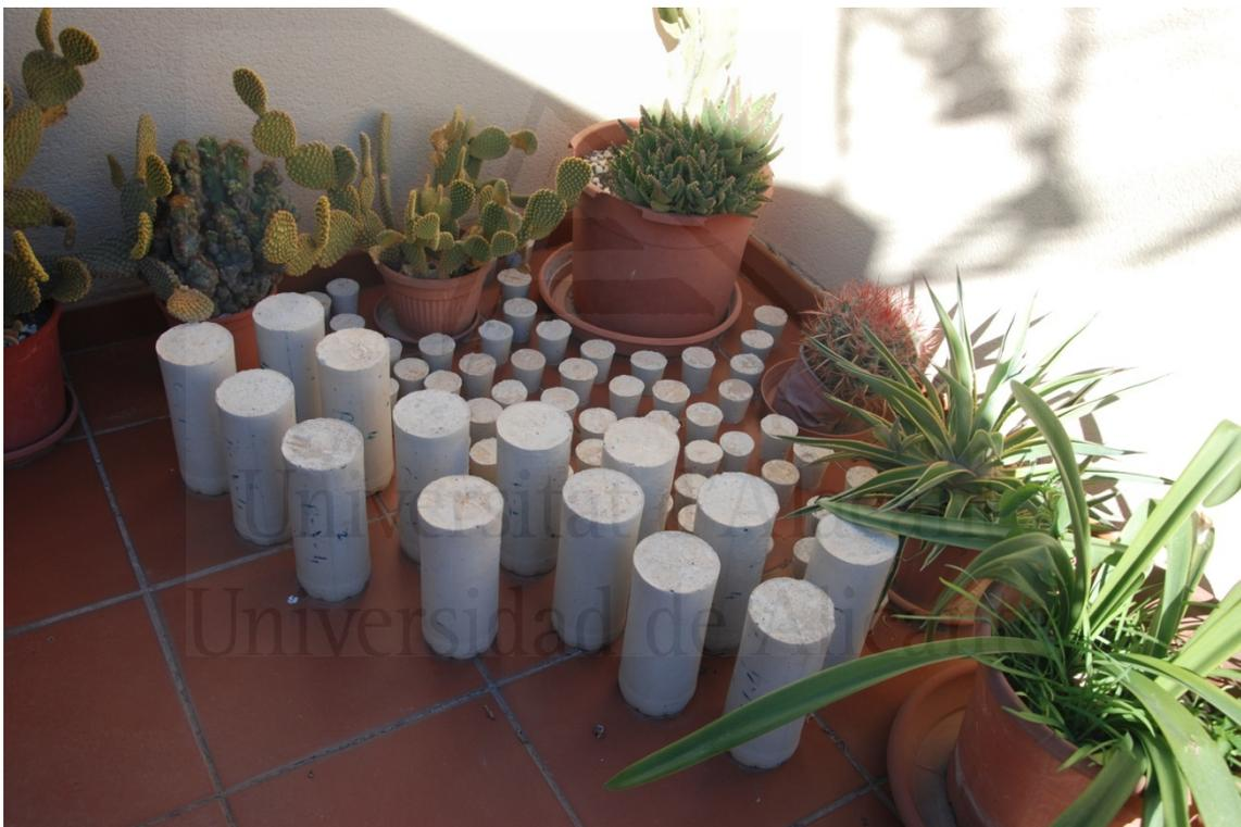
**Figura 3.1.** Imagen de algunas de las probetas estudiadas en este trabajo en la estación de exposición real a las condiciones del clima Mediterráneo.
