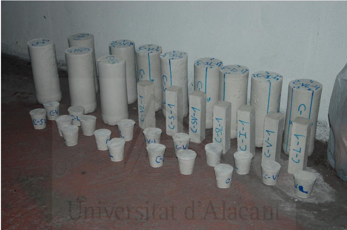
**Figura 3.4.** Fotografía de algunas de las probetas estudiadas en este trabajo en la estación de exposición real correspondiente a la clase XC3.
