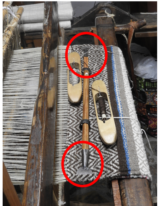
Figura 2. Templén montado en el telar (Foto de autor).
