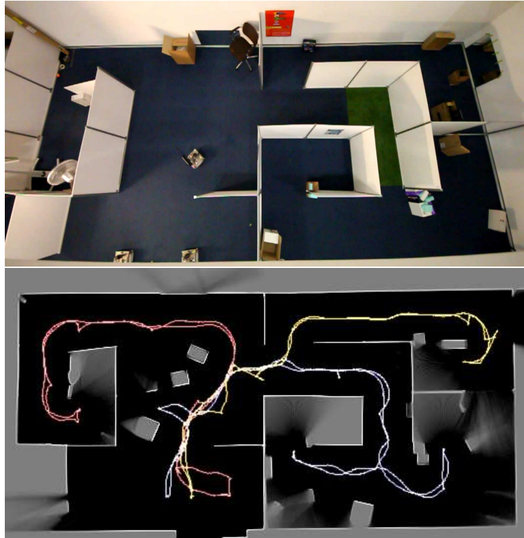
Figure 15. Photo de l'arène d'exploration et carte et trajectoires résultant de l'exploration de l'arène avec 3 robots
