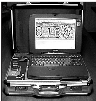
а) Прилад МО візуалізації «Вій-5А»
