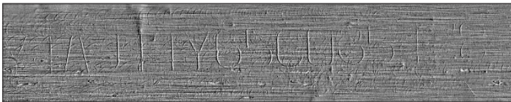
в) МО візуалізація полів внутрішніх напружень
