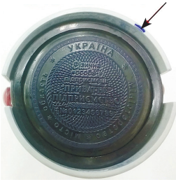
Рис. 7. Кліше печатки, із забрудненням оснастки фарбою
