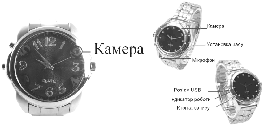
Рис. 11. Система прихованого відеозапису, вбудована в наручний годинник
