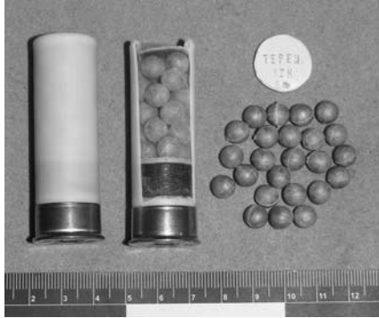
Рис. 1. Загальний вигляд патрона 12-го калібру травматичної дії «Терен-12К» та еластичної картечі, якою він споряджається
