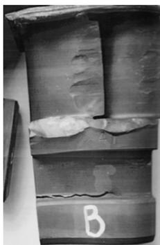
Рис. 2. Общий вид разрушенной лопатки
