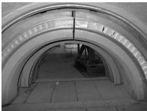
Рис. 3. Фотография направляющего аппарата первой ступени с повреждениями
