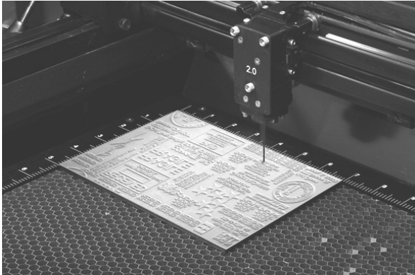
Рис. 2. Зображення на гумі, яке формується лазерним променем
