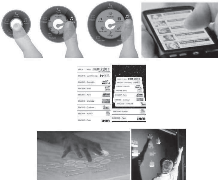
FIGURE 3. Déclinaison du menu. De gauche à droite et de haut en bas : le menu Wavelet sur téléphone mobile (le menu hiérarchique se déroule comme des vaguelettes imbriquées en déplaçant le doigt du centre vers la périphérie); la sélection d'un élément du menu par relâcher du doigt donne accès au résultat ou bien tant que le doigt est posé sur le menu, le résultat apparaît sur le menu en transparence donnant ainsi une idée de la nature des résultats [24] (principe du feedforward ); au centre, le Menu polymorphe 2D/3D; en bas, MTM (Menu MultiTouch) pour table interactive multipoints [2], Shadow Reaching : sélection de cible avec son ombre [44].
