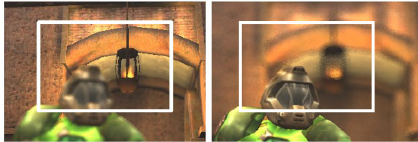
FIGURE 6.3 – Zone d’auto-focus (rectangle blanc) et influence du poids sémantique : (à gauche) auto-focus sans prise en compte de la carte sémantique - (à droite) auto-focus avec prise en compte de la sémantique : le net est fait sur le personnage.
