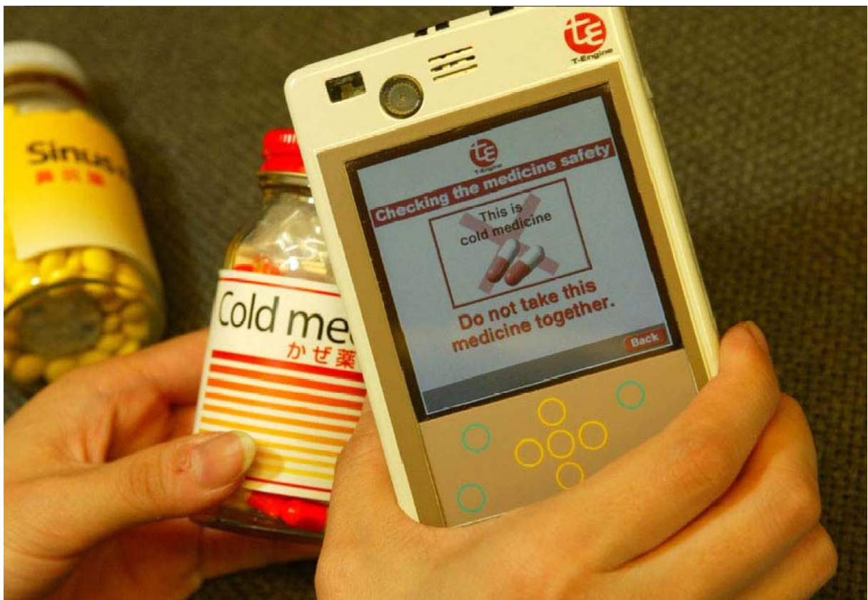
Figure 2 : Utilisation de l' « Ubiquitous Communicator » pour vérifier la compatibilité de médicaments (les boîtes intègrent des étiquettes RFID, le lecteur est dans l' « UC »)
