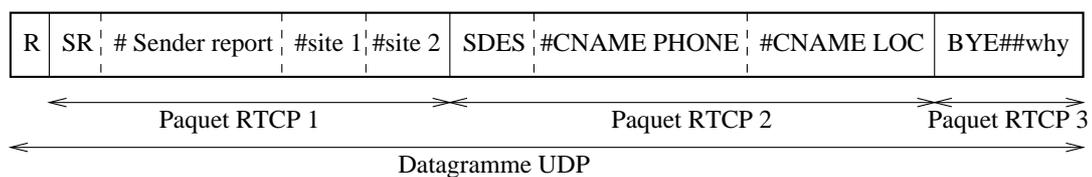
FIG. 5: Paquets RTCP concaténés dans un datagramme UDP
