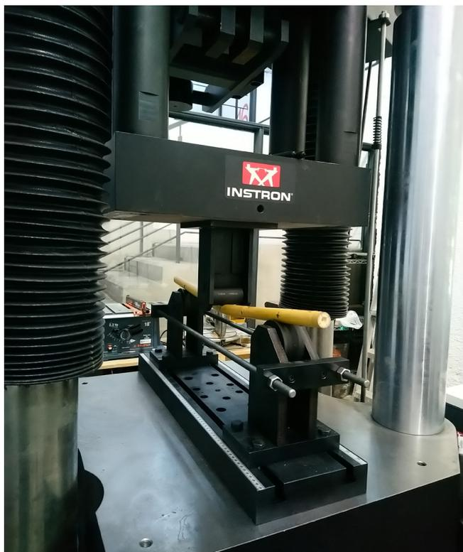
Figura 4. Máquina de pruebas universales INSTRON® modelo 400HVLB14362-G2A-C3-D28, Capacidad 200 toneladas.
