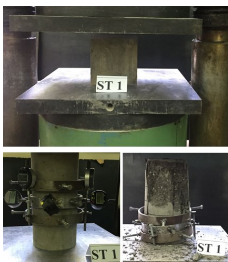
Slika 63: Određivanje čvrstoće betona ugrađenog u stubove pri pritisku
