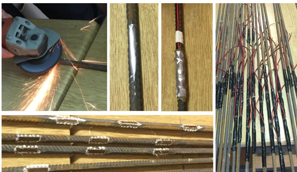
Slika 69: Postupak postavljanja mernih traka na armaturu
