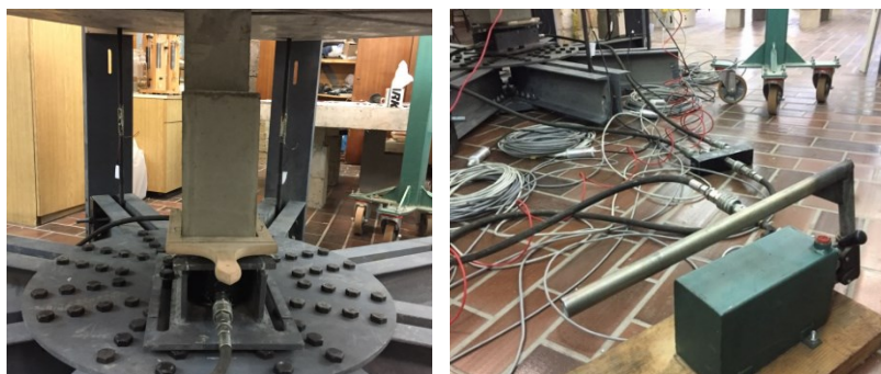
Slika 77: Postavljanje betonskog uzorka na hidraulične prese
