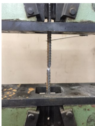
Slika 65: Utvrđivanje mehaničkih karakteristika armature
