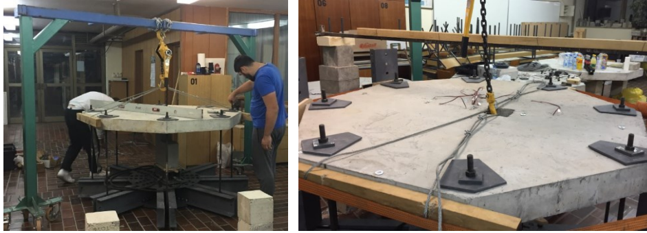
Slika 78: Postavljanje betonskog uzorka u horizontalan položaj
