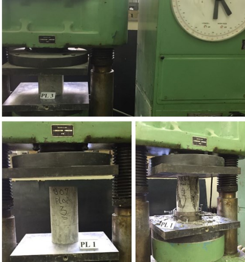
Slika 59: Određivanje čvrstoće betona ugrađenog u ploče pri pritisku
