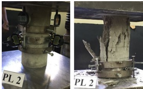
Slika 61: Određivanje modula elastičnosti i Poisson-ovog koeficijenta za beton ugrađen u ploče
