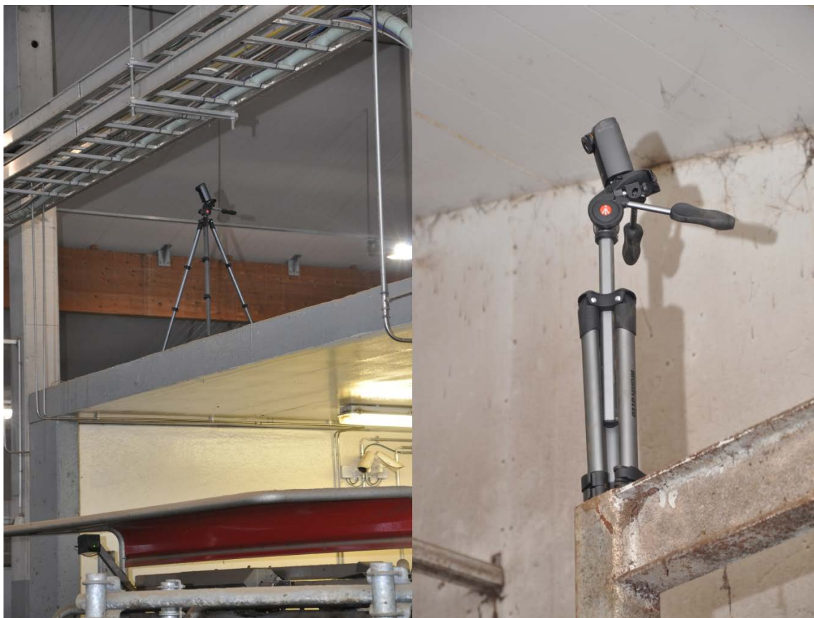
Kuva 1. Kamera robottikopin katolla ja tolpassa ruokintapöydän päässä (Koivisto 2016)
