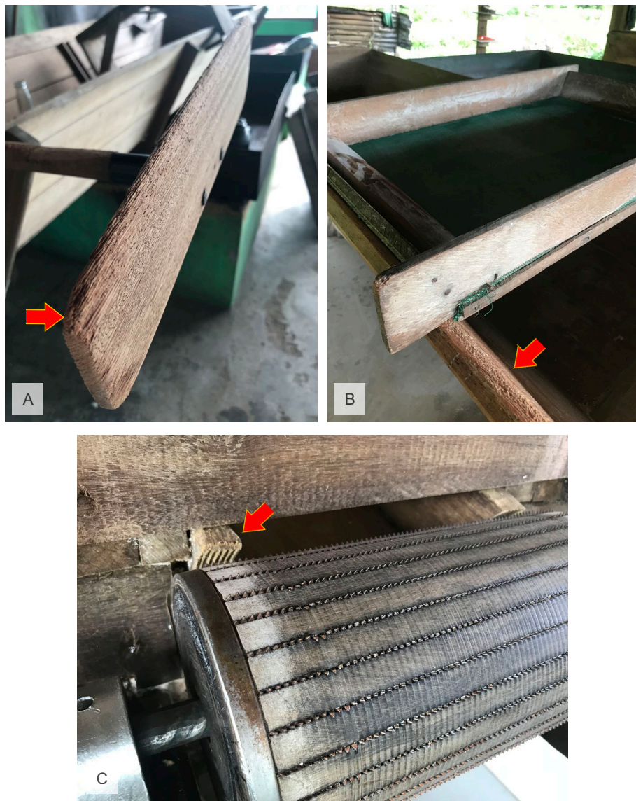
Figura 12. Detalhes de desgaste em equipamentos e utensílios de madeira utilizados em casas de farinha: rodo de tostagem (A), aro ou borda de apoio de peneira (B) e a chamada “língua da bola”, base que regula a abertura do triturador ou “caititu” (C).
