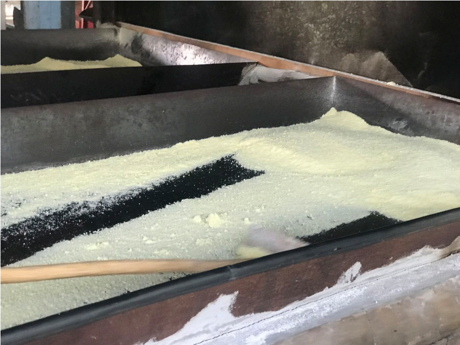
Figura 9. Fornos utilizados durante as etapas de branqueamento/tostagem do processamento artesanal de farinha de mandioca, Cruzeiro do Sul, Acre.
