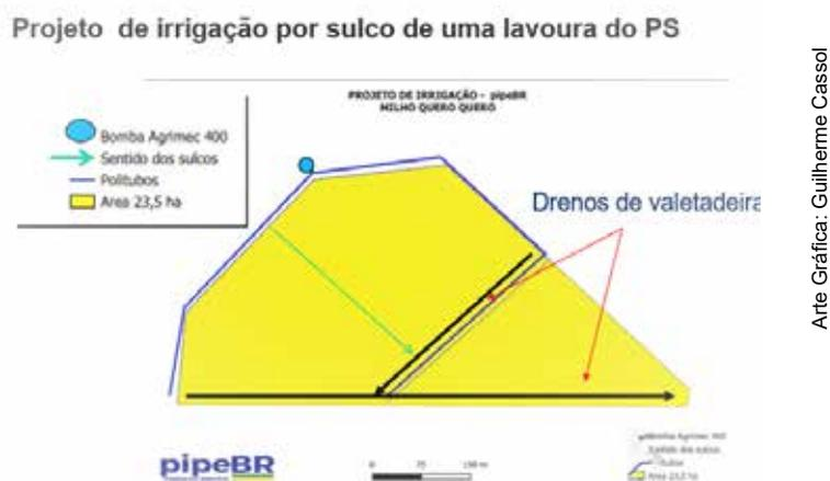
**Figura 11.** Projeto de um sistema de irrigação por sulco com o uso de politubos da PipeBR. Arte gráfica: Guilherme Cassol.
