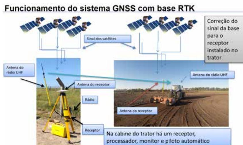
**Figura 5.** Equipamentos utilizados na base RTK (*Real Time Kinematic*) e no conjunto trator-plaina.
