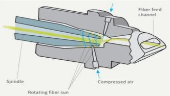
Fig. 03: Air-jet yarn formation (Vortex Spinning, Muratec)
