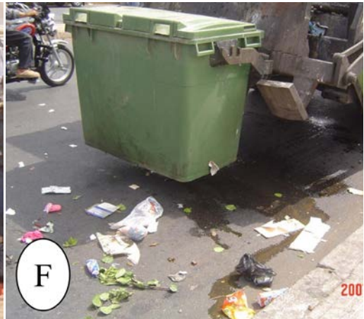
F – Camion qui déverse des lixiviats
