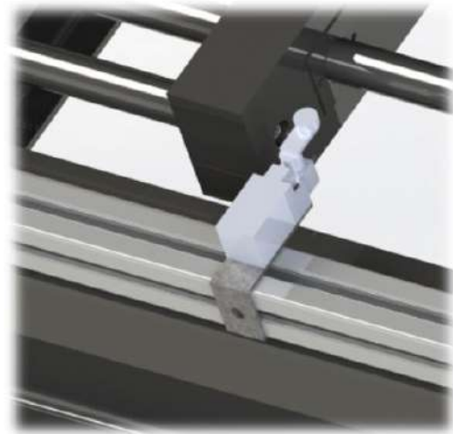
Figura 3.10: Aplicação e fixação do fim de curso na máquina.
