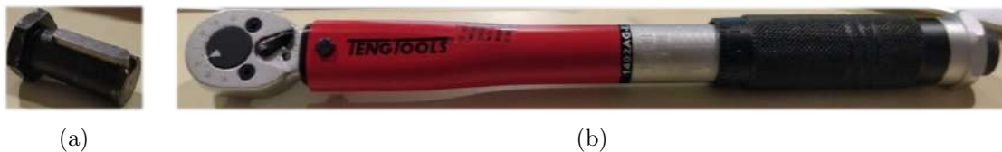
Figura 4.22: Chave dinamométrica e acessório: (a) Acessório usado para medição do binário, (b) Fotografia da chave dinamométrica usada.
