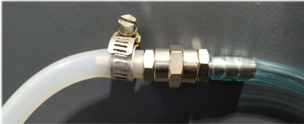
Figura 4.12: Fotografia de uma das uniões do tubo do refrigerador do defletor.
