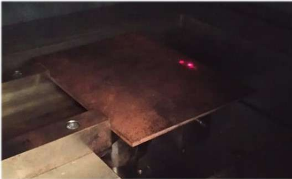
Figura 5.4: Fotografia do desalinhamento do feixe do laser e do seu guia.
