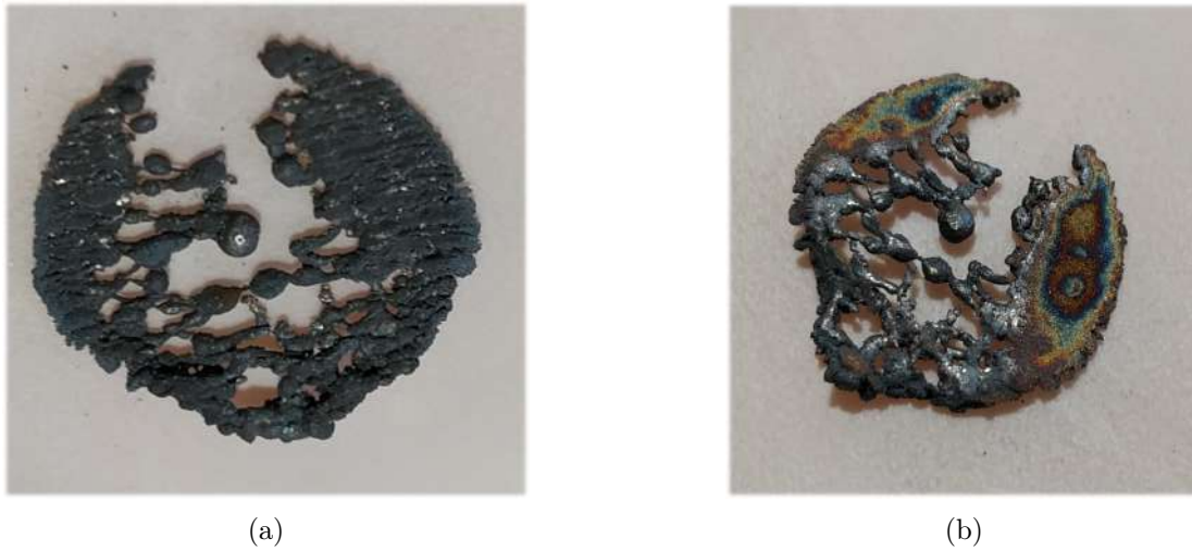
Figura 5.11: Teste de sinterização: (a) Fotografia da parte de cima da peça obtida, (b) Fotografia da parte de baixo da peça obtida.
