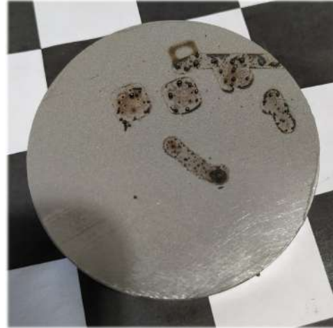
Figura 5.10: Fotografia do primeiro teste de sinterização da camada do pó.
