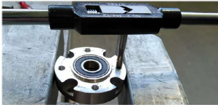
Figura 4.23: Fotografia do processo de roscagem do motorreductor.
