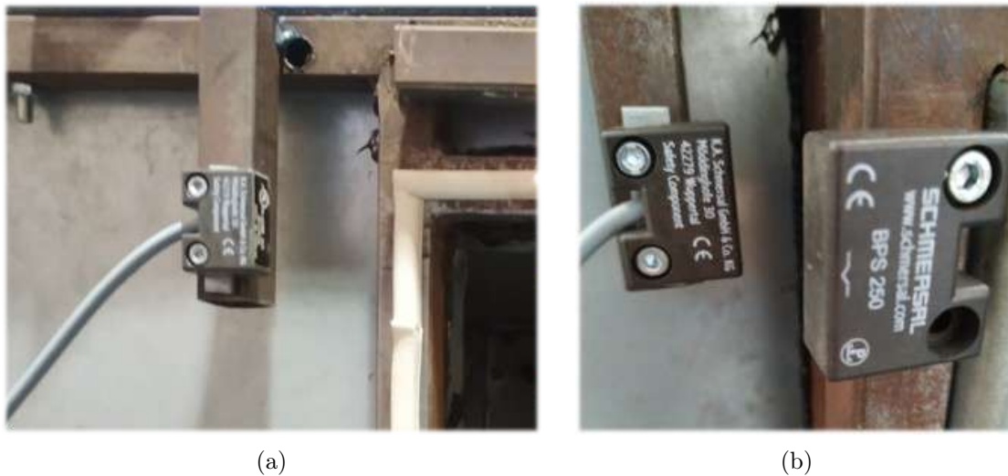
Figura 4.36: Aplicação do sensor de porta aberta na máquina: (a) Pormenor de aplicação do interruptor, (b) Montagem do interruptor e atuador magnético na máquina.
