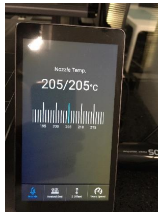
Fig. 40 Manipulação de parâmetros durante a impressão (opcional).
