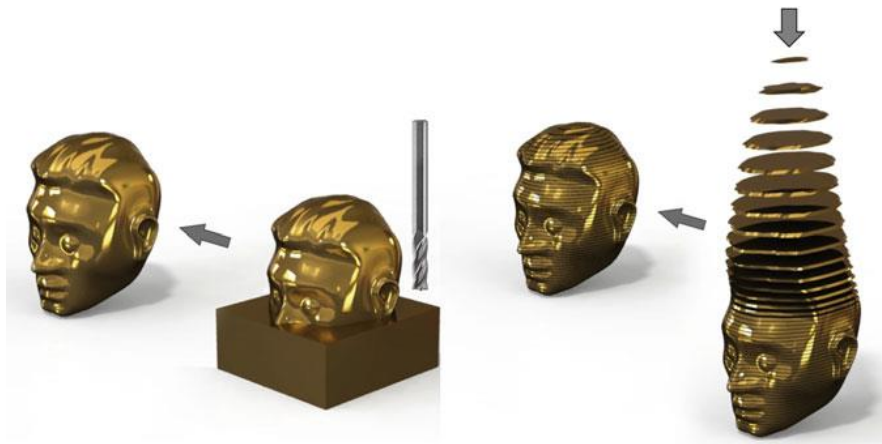
Fig. 17 Comparação método de produção: Maquinagem CNC vs Manufatura Aditiva. (Diegel, Olaf; Nordin, Axel; Motte, 2019)
