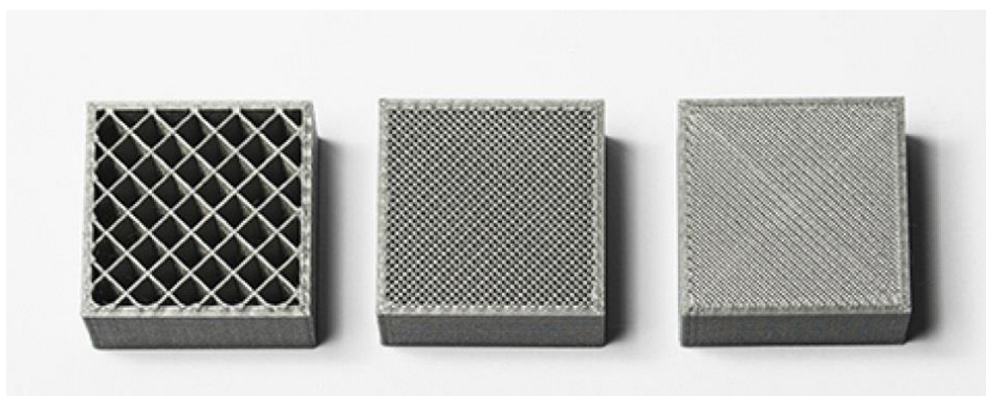
Fig. 33 Exemplo de diferentes densidades de preenchimento de uma geometria. (Redwood, Ben; Schöffner, Filemon; Garret, 2017)
