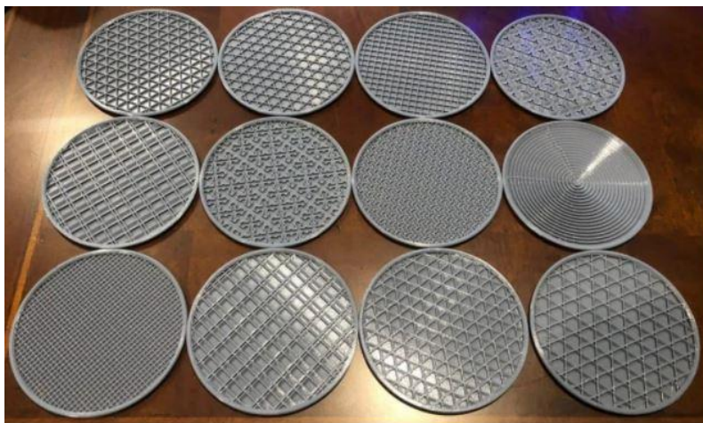
Fig. 43 Exemplo de faces com diferentes padrões de preenchimento. (3D Print Scape, 2021)
