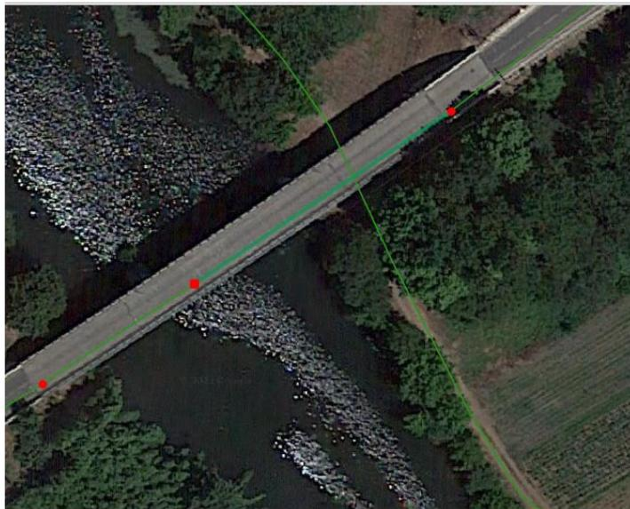
Figura 16 - Imagem de deteção de erro topológico segundo a regra: *Must not have pseudonodes* - QGIS
