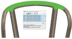
**Figura 83** Medição da área superior do encosto.
