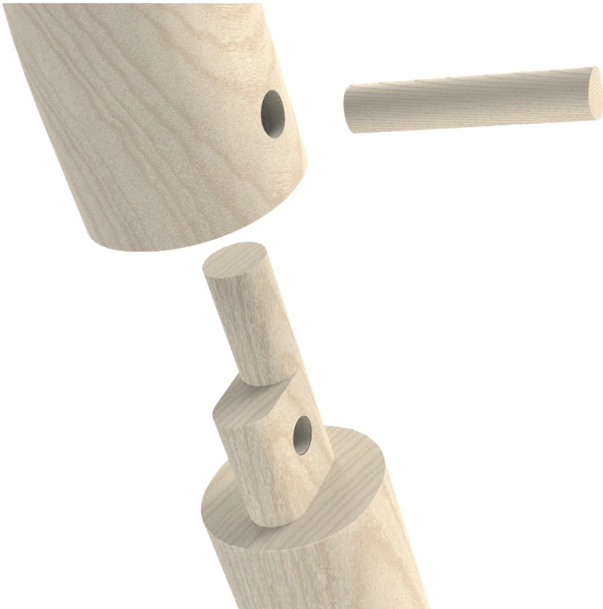
**Figura 101** Pormenor da cavilha inserida na espiga.
