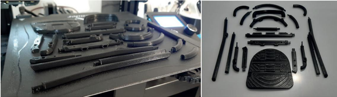
**Figura 74** Protótipo de impressão 3D dos vários componentes.
