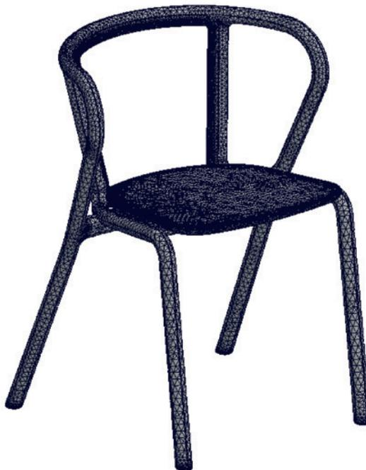
**Figura 85** Malha gerada com elementos tetraédricos de segunda ordem.
