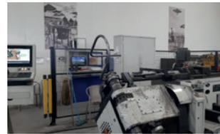
Figura 40 Processo de dobragem do tubo metálico da ADICO.
