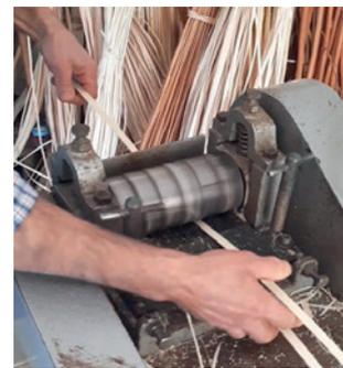
Figura 50 Passagem dos talos numa fiação.
