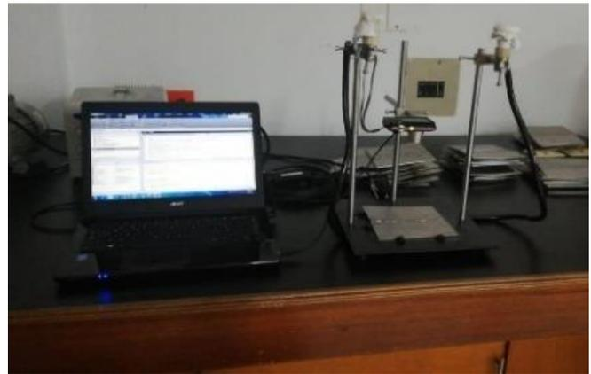
**Figura 3.** Dispositivo de inspección por visión artificial.
